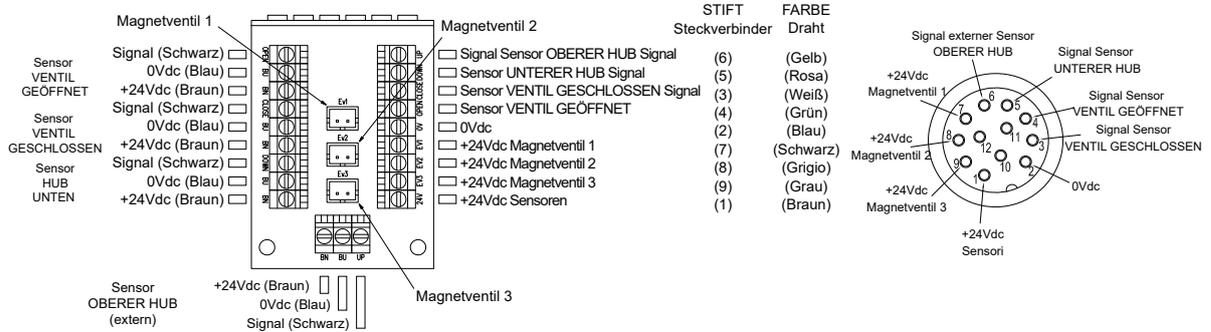
**Doppeldichtventil (PMO-Logik) 3 PNP-Sensoren mit 3 normalerweise geschlossenen Magnetventilen und 8-poliger M12 Steckverbinder**
