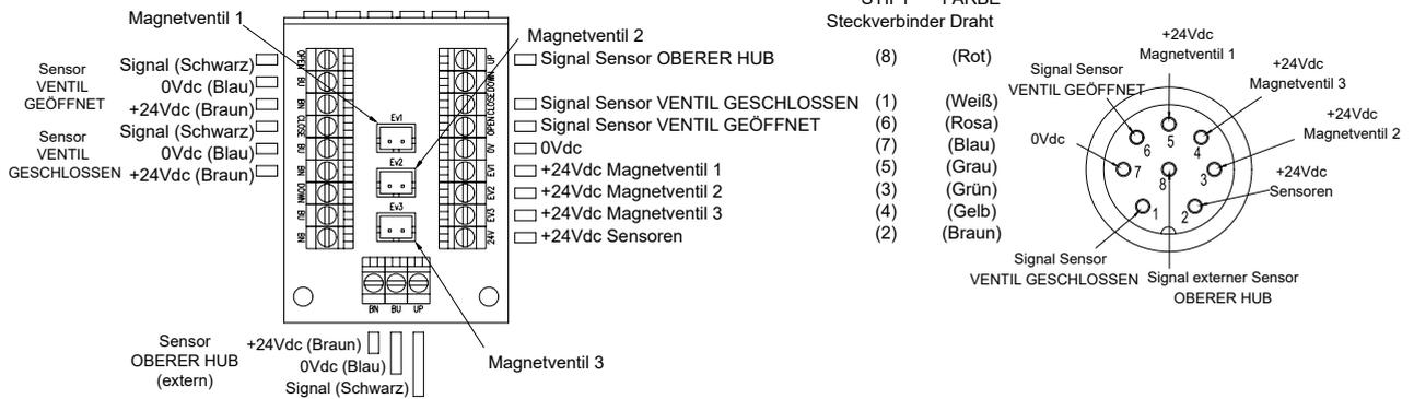
**1,2,3 PNP-Sensoren (unterer Hub) mit 1,2,3 stromlos geschlossenen Magnetventilen und 8-poligem Stecker**
