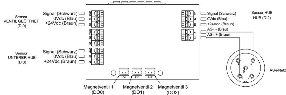
**2 PNP-Sensoren mit 1 normalerweise geschlossenem Magnetventil für BBZS5**
