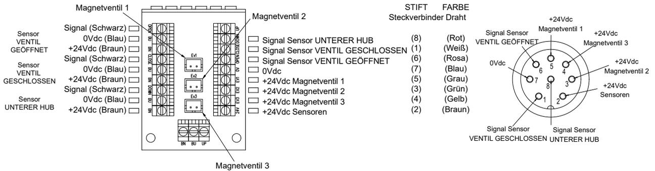
**1,2,3,4 PNP-Sensoren mit 1,2,3 normalerweise geschlossenen Magnetventilen**
