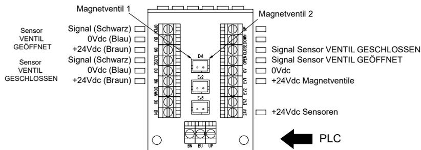
**AS-i-Karte 360° mit 1,2,3,4 PNP-Sensoren und 1,2,3 normalerweise geschlossenen Magnetventilen**
