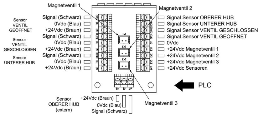
**1,2 PNP-Sensoren mit 2 Magnetventilen (1 NC und 1 NO) für Doppelwirkung**
