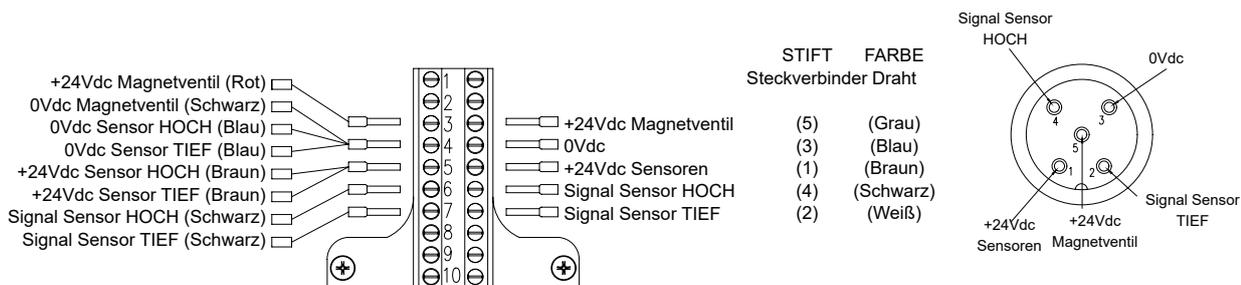
**1,2,3,4 PNP-Sensoren mit 1,2,3 normalerweise geschlossenen Magnetventilen und 12-poliger Steckverbinder**
