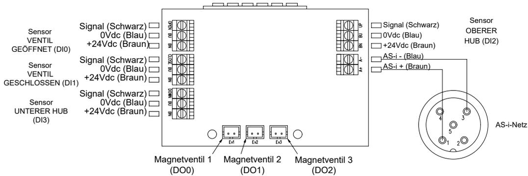
**AS-i-Karte 360° mit 1,2 PNP-Sensoren und 2 Magnetventilen (1 NC und 1 NO) für Doppeltwirkung**
