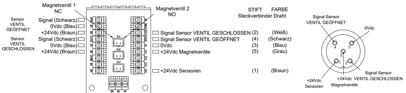
**1,2,3 PNP-Sensoren (Oberhub) mit 1,2,3 stromlos geschlossenen Magnetventilen und 8-poligem Stecker**
