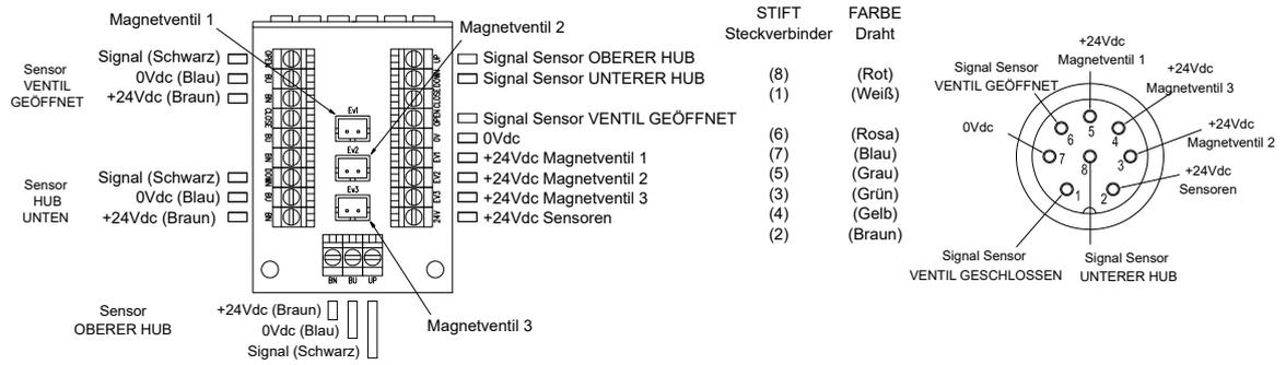
**Doppeldichtventil (PMO-Logik) mit AS-i-Karte 360°, 3 PNP-Sensoren und 3 normalerweise geschlossenen Magnetventilen**
