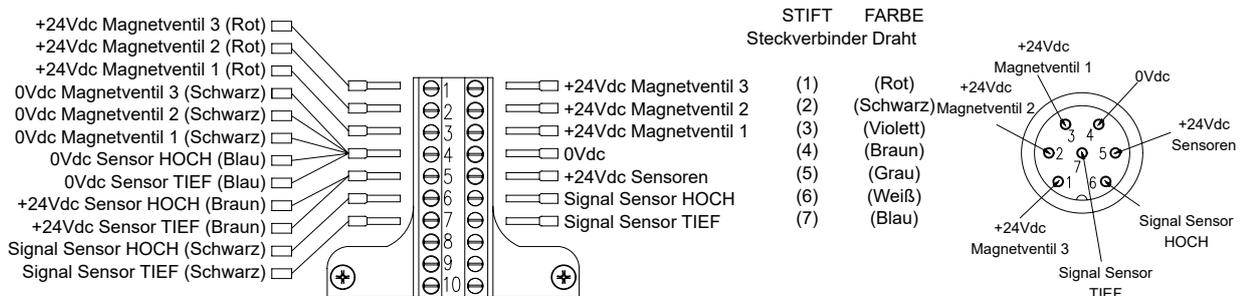
**1,2,3 normalerweise geschlossene Magnetventile und 5-poliger Steckverbinder**
