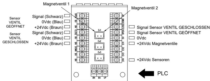
**1,2 normalerweise geschlossene Magnetventile und 7-poliger Steckverbinder**
