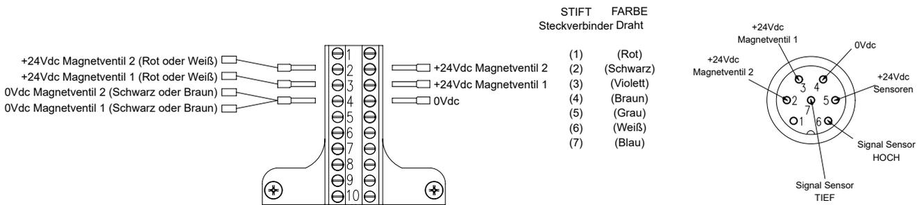
**1,2 normalerweise geschlossene Magnetventile und 5-poliger Steckverbinder**
