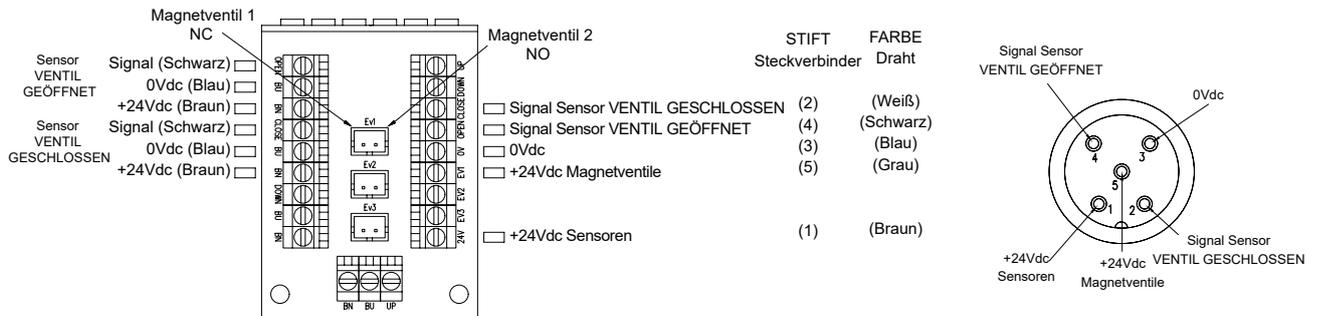
**1,2 PNP-Sensoren mit 1,2 normalerweise geschlossenen Magnetventilen**
