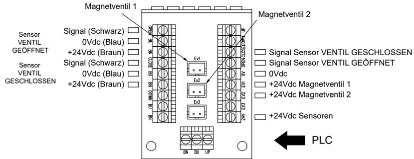
**1,2 PNP-Sensoren mit 2 Magnetventilen (1 NC und 1 NO) für Doppelwirkung**
