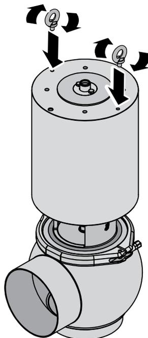
Une fois la vanne installée il est nécessaire de retirer les œillets et de réinstaller les vis.
