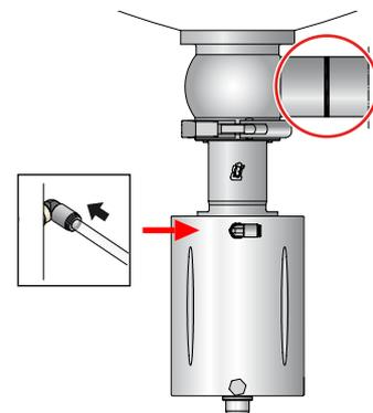
Тщательно выполнить сварку. Постараться произвести сварку без создания напряжений в материале, чтобы избежать деформаций на участках уплотнений. Проверить работу клапана после сварки.
