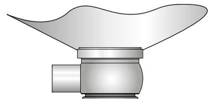
Utilizar exclusivamente soldadura por arco pulsado sin dejar espacios entre la brida y la placa del depósito. Soldar por puntos en el lado opuesto (8 segmentos con metal de aporte). Si es posible, soldar la raíz sin metal de aporte. La soldadura final se debe realizar con 8 segmentos para evitar grietas.
