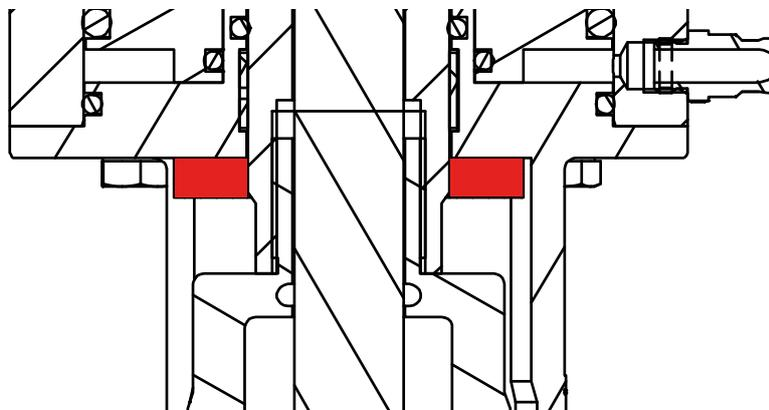
Eeguire il lift superiore della valvola e verificare che il sensore commuti lo stato in presenza della camma, nel caso non succedesse niente regolare il sensore.
