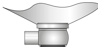
Utiliser uniquement le soudage à l'arc pulsé et ne pas laisser d'espace entre la bride et la plaque du réservoir. Effectuer une soudure par points toujours sur le côté opposé (8 segments avec métal d'apport). Si possible souder la racine sans métal d'apport. La soudure finale doit être effectuée en 8 segments afin d'éviter toute formation de fissures.
