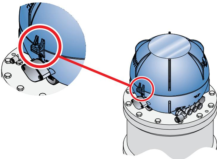
**10.16 Hydraulischer Dämpfer für 207-360 Zylinder**
